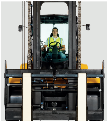
Wellengeführter Standardgabelträger mit Gabelzinkenverstellung und 10 bis 12 Tonnen Tragfähigkeit
